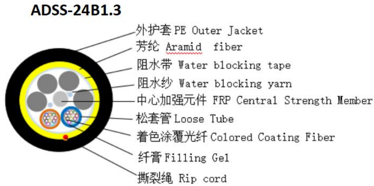
光缆结构图 Profile View
