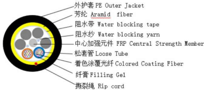
光缆结构图 Profile View
